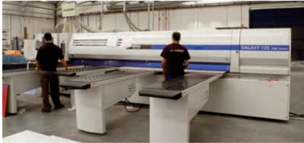
Seccionadora de tableros automática con carga trasera.
